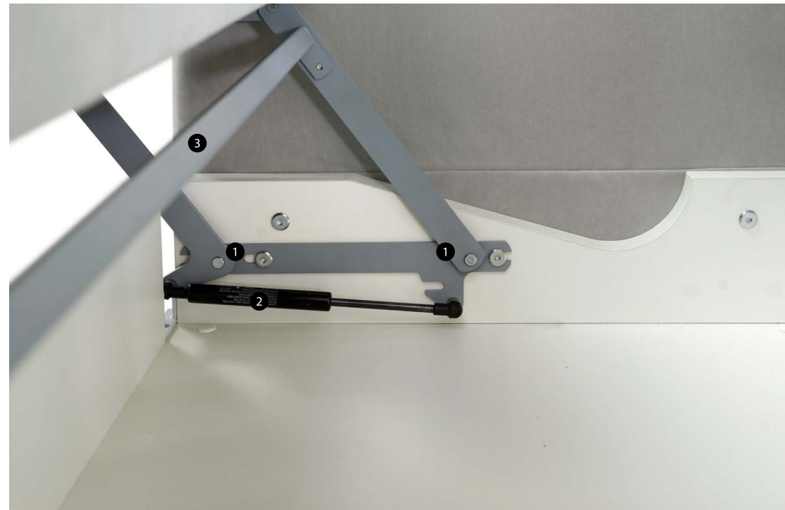
Механизм трансформации: рычаги с полиамидными подшипниками скольжения ①, газлифтом ② и поперечным синхронизатором ③ системы «антиперекося»
